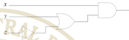
Figura 11.5.5 Circuito combinatorio con tres compuertas equivalente al de la figura 11.5.4.
