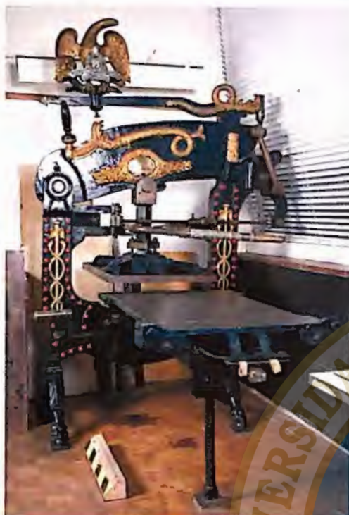
Prensa para relieve Columbian construida en Londres en 1844.
