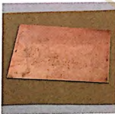
Es mejor no pulir demasiado la superficie de la lámina de cobre mientras se realiza el aguafuerte.
