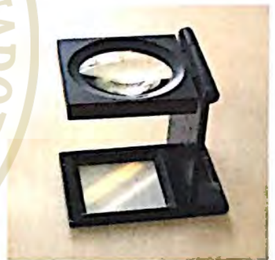
Resulta conveniente tener una lupa para comprobar la profundidad de la línea grabada.
