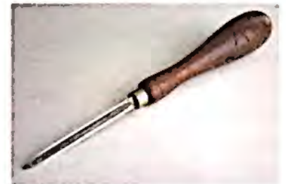
Un rascador de tres caras que se utiliza para eliminar la rebaba.
