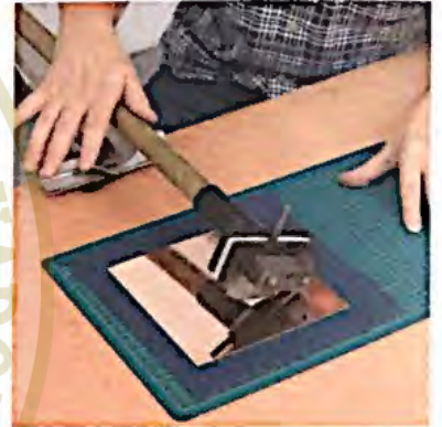
6 Observe el peso que se ha situado en la parte exterior del graneador para proporcionar la presión deseada. Observe también el artillugio colocado para sujetar el mango, que proporciona facilidad y consistencia cuando se realiza el graneado.
