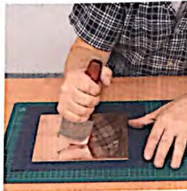
3 Comience con una pasada central. La plancha debe permanecer fija.
