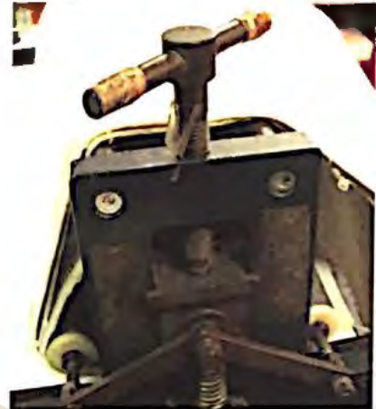
Tornillo de presión de la prensa eléctrica de polimetalo.
