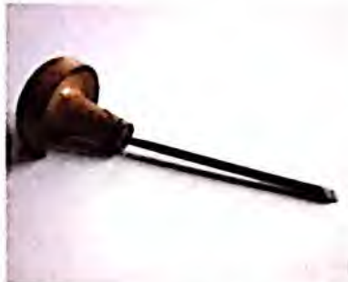
Buril en forma de losange y con la varilla doblada preparada por S. W. Hayter (véase pág. 149).
