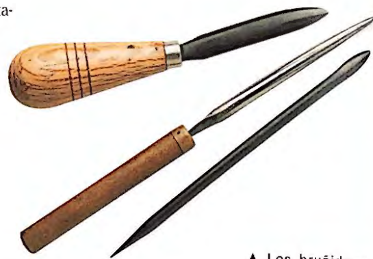
▲ Los bruñidores actúan aplastando el grano con la finalidad de sacar los blancos más puros y las tonalidades más delicadas. En la imagen se reproducen varios modelos: con los más pequeños se precisan los acabados, y los más anchos permiten abordar zonas más grandes.
