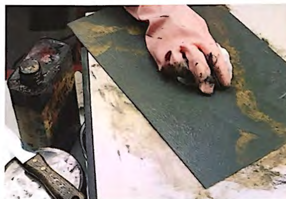
▲ Sustrayendo la tinta sobrante con un trapo sucio.
