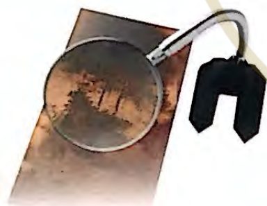
▲ Detalle del toner transferido sobre plancha analizado a través de una lupa.
