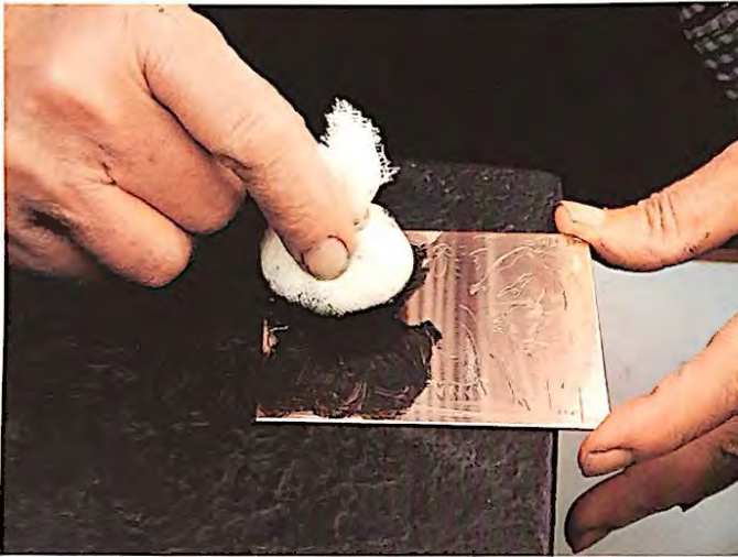
▲ 8. La muñeca embadurna cuidadosamente de tinta la superficie de la plancha mientras ésta descansa en el caliente-planchas.
