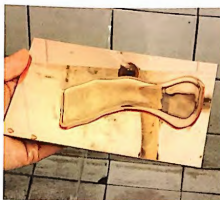
▲ Plancha de cobre engrasada; el agua no se puede estancar en su superficie al ser repelida por la grasa.
