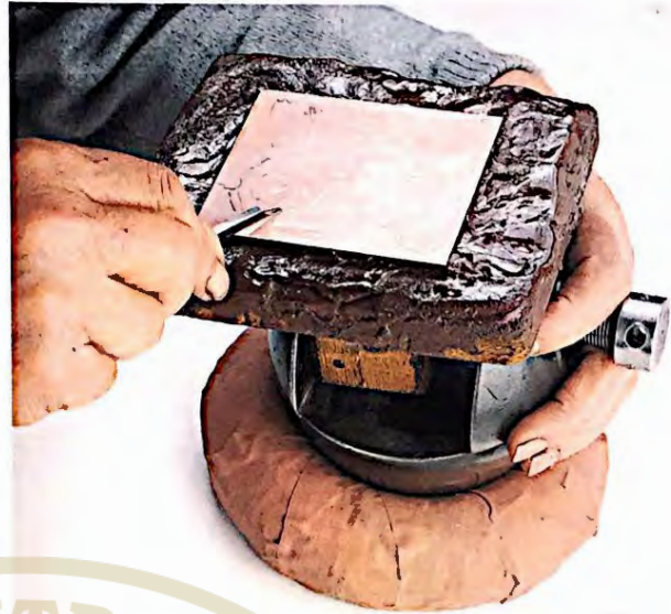
▲ 4. Una mano sujeta la bola y la hace girar según las necesidades del trazo, mientras que la otra empieza a grabar después de asegurar un buen afilado del buril tal como se explica en el paso a paso de la xilografía a contrafibra.
