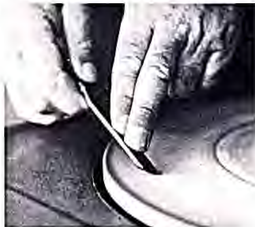
Afiladura de la gubia curva en una muela de afilar mecánica.
