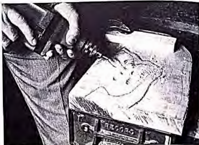
Vaciado de una tabla de madera con un taladro eléctrico y un cabezal rectificador.
