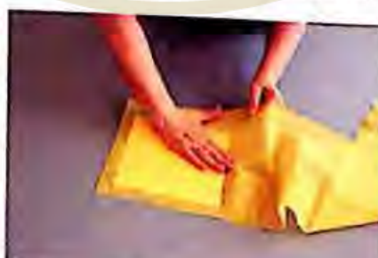
5. La tela de serigrafía se une a la superficie de la plancha con adhesivo en spray. Para que se peguen bien, pulverice con adhesivo tanto la plancha como la tela.
