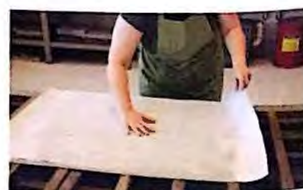
3. Enjuague y seque la plancha con rapidez, ya que la humedad del enjuagado volverá a iniciar el proceso de oxidación
