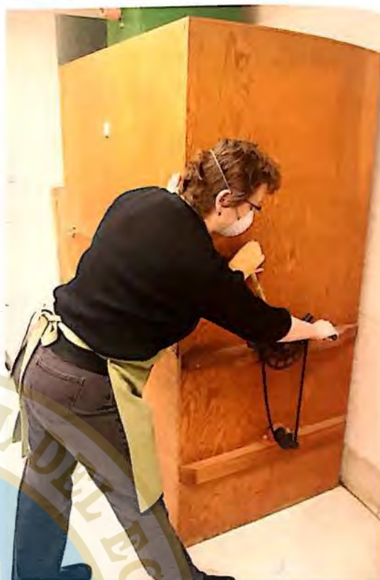
1. Agite el polvo de la caja de resinar.
