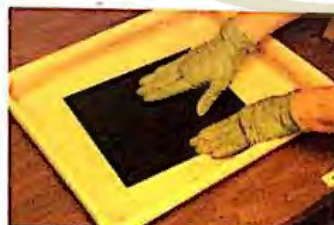
2. Introduzca la plancha en la solución de revelado durante varios minutos; siga las instrucciones para el film concreto que utilice. Si la plancha va a grabarse, debe seguir revelándola hasta que el metal sea claramente visible en todas las zonas de la imagen.
