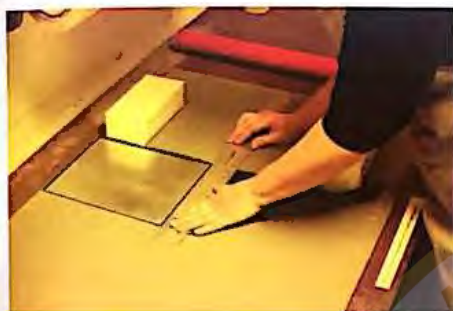
1. Corte un trozo de film ligeramente mayor que la plancha.
