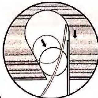
En este sistema de secado se coloca una bola; al insertar el papel, ésta cae para colocarlo en su sitio.
