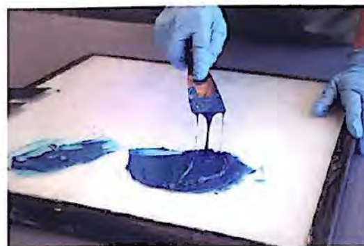
● Con el fin de determinar la longitud y la fluidez de la tinta, levántela de la placa con el lado ancho de la espátula. Una tinta rígida y seca se romperá con rapidez, mientras que una tinta flexible se alargará.
