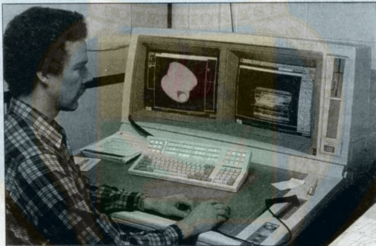
Figura 4.33. Estación de trabajo con pantalla doble (cortesía de Intergraph Corp.)
