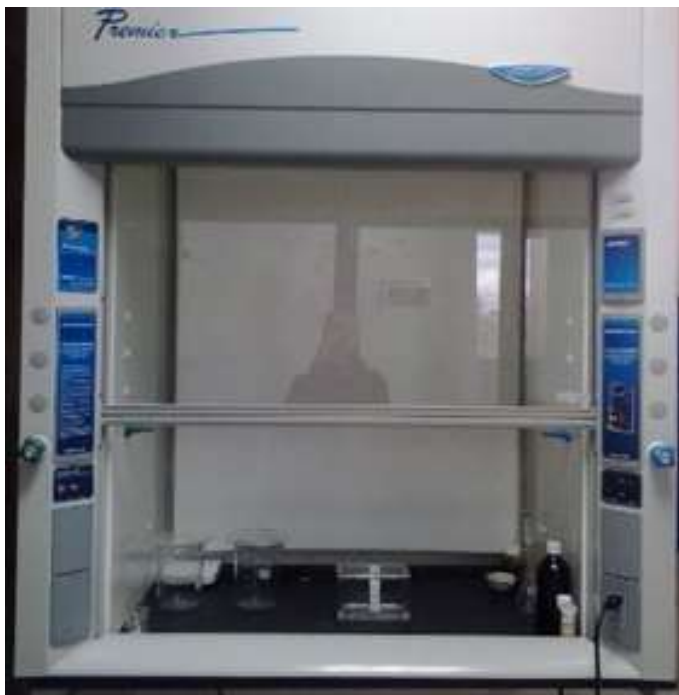
Figura 1.11. Campana de extracción de gases. Fuente: El autor (2019).
