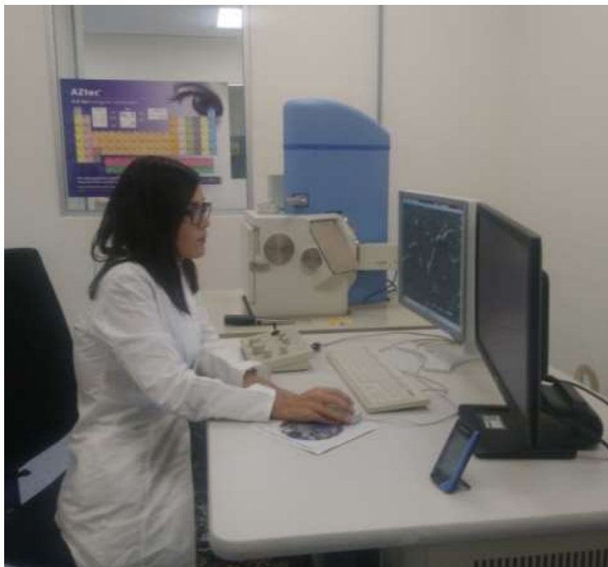
Figura 12.25. Microscopio Electrónico de Barrido (MEB) JEOL-6610LV. Fuente: Instituto Transdisciplinar de Investigación y Servicios – ITRANS. Universidad de Guadalajara.
