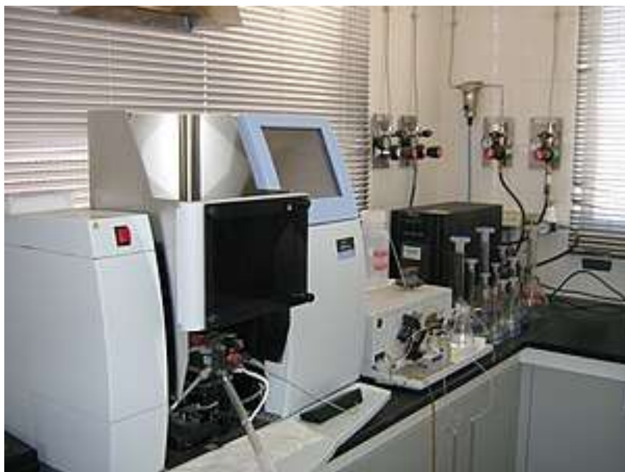
Figura 12.30. Equipo de Absorción Atómica (AA) asociado a un Generador de Hidruros. Fuente: Wikipedia.
