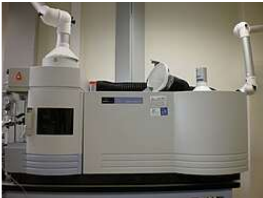
Figura 12.31. Espectrómetro de emisión atómica de plasma acoplado inductivamente. Fuente: Wikipedia.
