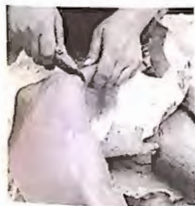
24. Justo por encima de la superficie exterior del molde, y con un cuchillo afilado, se cortan el bebedero y el respiradero.
