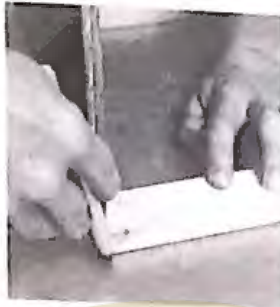
Estratificado 1. Se construye la estructura que se va a estratificar. Se pone sobre una superficie de trabajo metálica encerada y se marca el contorno del borde.
