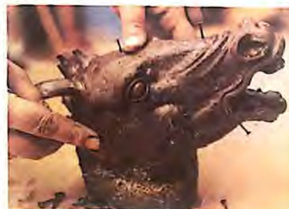
Confección de un macho en una cera hueca 1. Se apoya la cera sobre una base blanda. Se hace la mezcla de cemento para el macho y se vierte en el interior de aquella.
