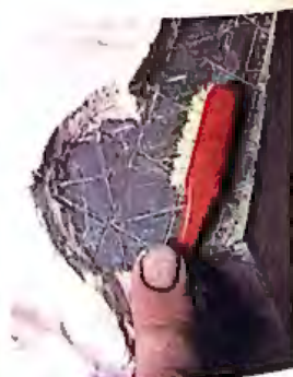
6. Se quita el molde de yeso rompiéndolo y se cepilla la superficie del vaciado. El yeso deja una película blanca en la superficie.
