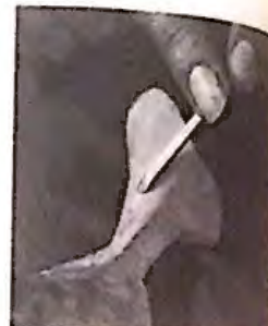
2. También puede usarse un escoplo fino, impulsado sólo con la mano porque la fuerza de un golpe de mazo puede rajar la madera.
