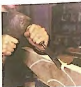
2. Siguiendo la línea marcada se utiliza un escoplo para quitar la madera sobrante entre los cortes de la sierra.
