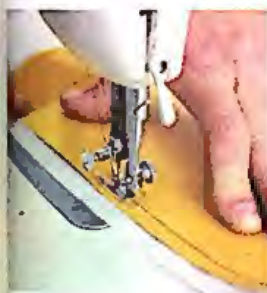
Unión de láminas de PVC 1. Se unen las dos piezas cosiéndolas a máquina con un hilo fuerte. Debajo del PVC se coloca un papel de seda.
