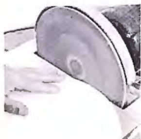
3. Con una amoladora de banco se lijan los bordes de corte para ajustarlos exactamente a la marca, ya que la sierra no corta con la precisión necesaria.
