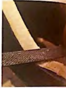
7. Se suaviza la segunda curva con la escopina, como se hizo con la primera. Ahora la forma ya está perfectamente definida.
