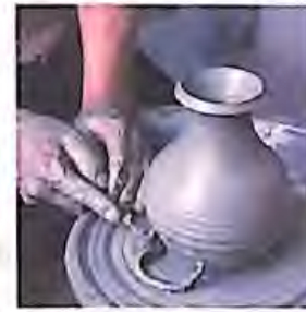
12. Se mantiene ligeramente apretado contra la base para perfeccionarla, un perfil de acero. Se para la rueda y se corta con un alambre por debajo de la base.
