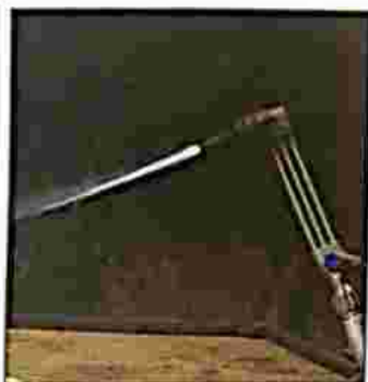
8 Se abre la válvula de oxígeno.
