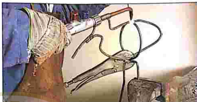
3 Se sujeta la sección correspondiente a las patas y al cuerpo en un tornillo de banco metálico, se sitúa la silueta del pájaro en ángulo recto respecto a la sección del cuerpo mediante unas tenazas de presión y se sueldan ambas secciones entre sí.
