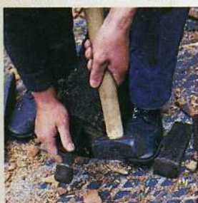
Cachado de la madera 1. Se pone una cuña de metal en el lado serrado de un tronco y se hace entrar en éste golpeándola con un martillo.
