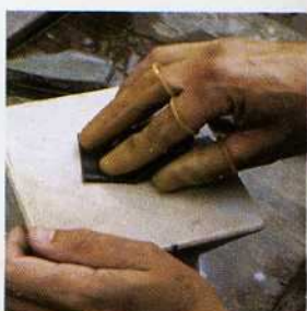
4. Por último, para el pulimento final de la superficie se emplea papel de carborundo.
