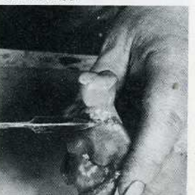
11. La herramienta caliente funde la cera y a la vez va dando forma suavemente. Se trabaja primero la forma básica.
