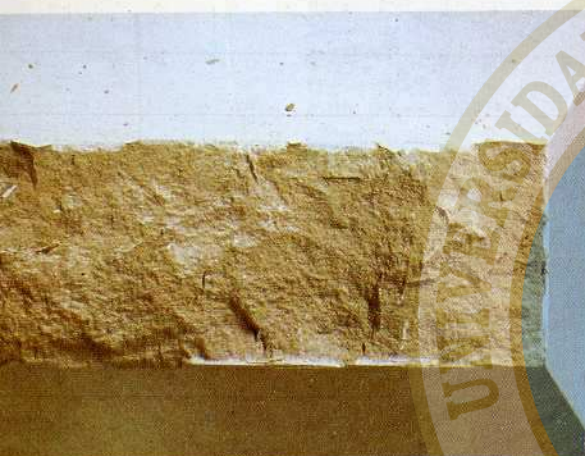
2. Se trabaja gradualmente a lo largo del borde de la piedra, partiendo de uno de los extremos y labrando hacia el centro.
