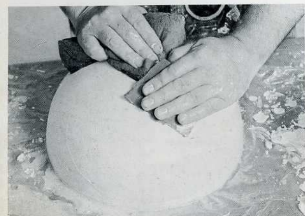
4. La capa de yeso se refuerza con cañamazo empapado en la mezcla y enrollado alrededor de la forma circular.
