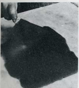
4. Con un cuchillo plano de hoja ancha se levanta la cera del mármol teniendo mucho cuidado de que la lámina salga entera.
