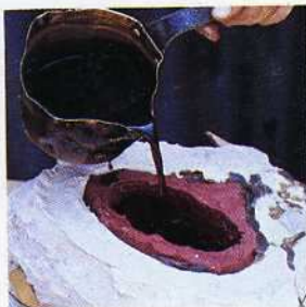
Confección de una cera hueca con el método de vertido y volteado 1. Se cuela una pequeña cantidad de cera fundida en el interior del molde.
