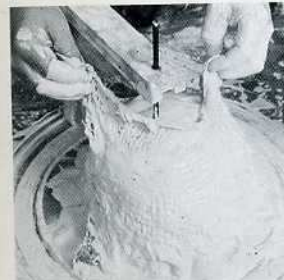
4. La capa de yeso se refuerza con cañamazo empapado en la mezcla y enrollado alrededor de la forma circular.
