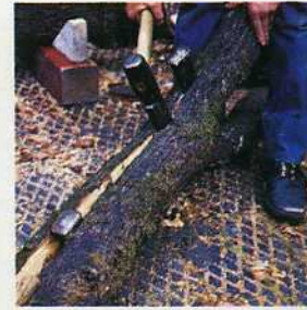
4. Se toma entonces la primera cuña y se coloca detrás de la segunda. Se golpea con el martillo para alargar la raja.
