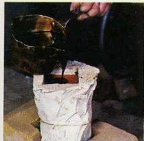
2. En una cacerola se funde la cera suficiente para llenar el molde, en el que se cuela lentamente.
