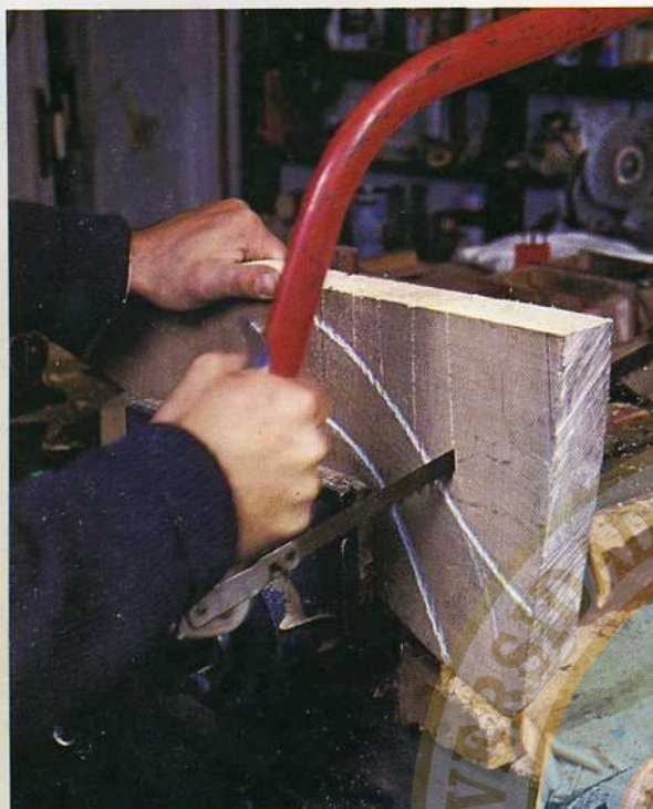
Corte de la madera sobrante 1. Se marca en la madera la forma deseada; se sujeta aquélla en un tornillo de banco y se hacen cortes verticales, hasta la marca de tiza con una sierra de arco.
