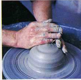
3. Se empieza a girar el torno; con ambas manos húmedas se comprime la arcilla conduciéndola hacia el centro del torno.
