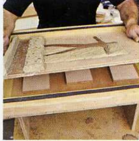
3. Se coloca el modelo en la caja de vacío. Debe quedar por debajo del borde superior de aquella y despegado unos 3 mm. en todo el contorno.
