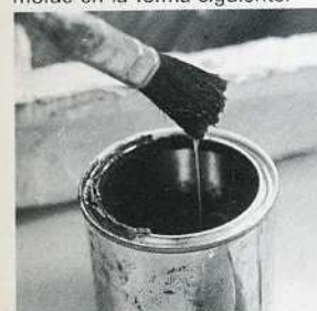
4. Se da una capa de agente separador sobre las capas anteriores, con lo que el molde queda preparado para el vaciado.
