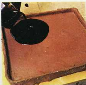
Vaciado de una lámina de cera 1. Se hace con este fin un molde plano flexible. Se calienta la cera y se cuela en el molde.
