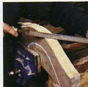
4. Se alisa la superficie de corte con una escofina, utilizando el lado plano de la misma sobre las curvas convexas.
