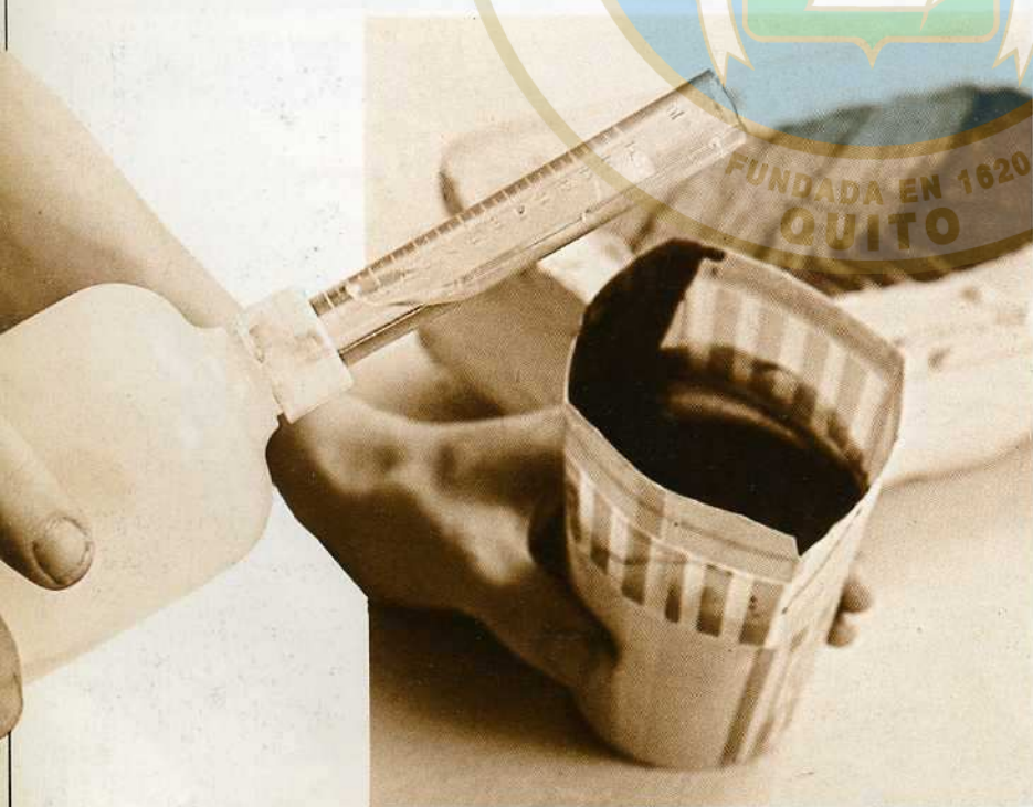
7. Se mide el catalizador en un frasco graduado, 10 cc. para 1 kg. de gel. Se vierte sobre éste y se mezcla concienzudamente.
