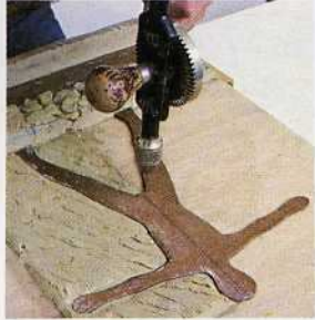
2. Se hacen pequeños agujeros de ventilación en el tablero base para garantizar un moldeado estanco. El modelo no debe tener cortes sesgados ni en ángulos rectos.
