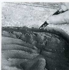
2. Se modela la forma y cuando haya alcanzado la consistencia del cuero se separa de la base con un cuchillo de hoja larga.
