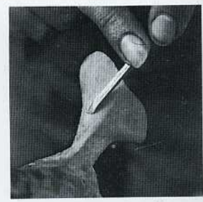
2. También puede usarse un escoplo fino, impulsado sólo con la mano, porque la fuerza de un golpe de mazo puede rajar la madera.
