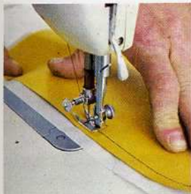
Unión de láminas de PVC 1. Se unen las dos piezas cosiéndolas a máquina con un hilo fuerte. Debajo del PVC se coloca un papel de seda.
