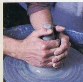
4. Se rodea la arcilla con ambas manos y se le va dando forma de cono. Los brazos han de estar siempre apoyados sobre la mesa del torno.
