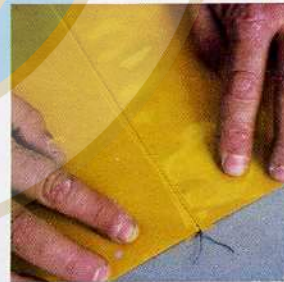
4. Se da la vuelta al PVC y se alisa a lo largo de la costura, que ha quedado fuerte y hermética para el aire.
