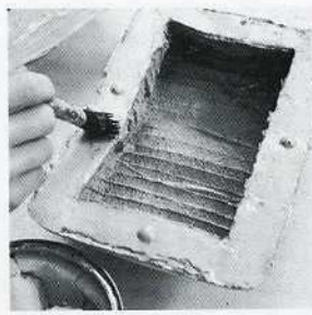
3. Una vez seca la goma laca, se aplica a pincel sobre todo el molde una capa fina y uniforme de cera, con cuidado de que no desaparezca la textura.
