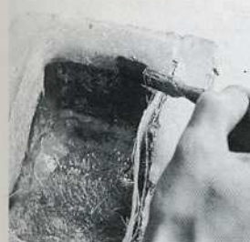
13. Se aplica una tira de «mat» alrededor de una de las secciones del molde asomando la mitad por encima del borde. Se impregna de resina la mitad inferior.
