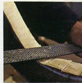
7. Se suaviza la segunda curva con la escofina, como se hizo con la primera. Ahora la forma ya está perfectamente definida.
