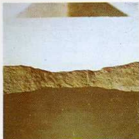
2. Se trabaja gradualmente a lo largo del borde de la piedra, partiendo de uno de los extremos y labrando hacia el centro.
