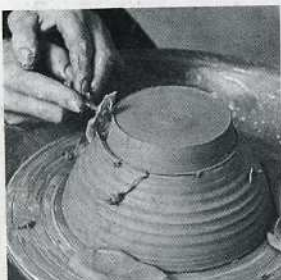
Torneado 1. Se perfecciona la base de la vasija cuando tiene la consistencia del cuero; ésta se centra boca abajo y se calza con arcilla húmeda.
