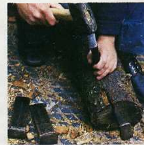
5. Se repite el proceso hasta que el tronco se separe en dos piezas. Con un destal se cortan las fibras que todavía las mantienen unidas.
