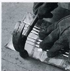
3. Se pone la chapa metálica sobre un banco de trabajo y se martilla a lo largo de los bordes para quitarle el doblez.
