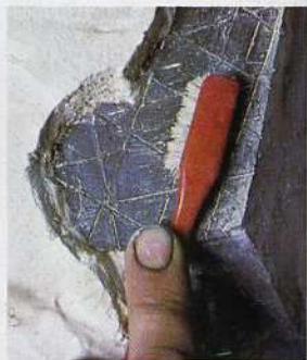
6. Se quita el molde de yeso rompiéndolo y se cepilla la superficie del vaciado. El yeso deja una película blanca en la superficie.
