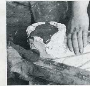
22. Se golpea el yeso con una paleta de madera para eliminar las burbujas de aire y se deja enfriar por completo el molde.
