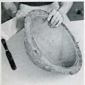
2. Para desmoldear el vaciado primero se golpea por todo el exterior del molde con una pieza de madera para que aquél se suelte.
