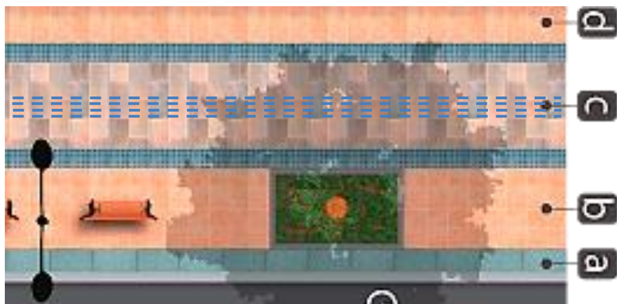
Gráfico 62: tramo de acera, en donde se puede apreciar la franja de circulación (c) delimitada por dos bordes azules. Estos bordes azules son adoquines con texturas que son las señales táctiles horizontales de advertencia, que indican a la persona con discapacidad visual, los límites del camino por donde puede circular con seguridad. Al medio de la franja de circulación, se puede apreciar la señal podotáctil guía.
