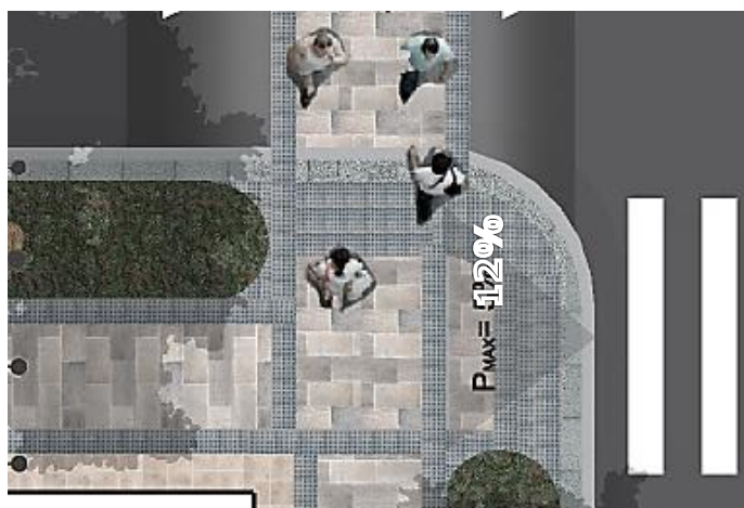
Gráfico 68: rampa que se desarrolla entre las franjas de servicio y de seguridad, la amplitud de la franja de servicio, facilita esta solución.
