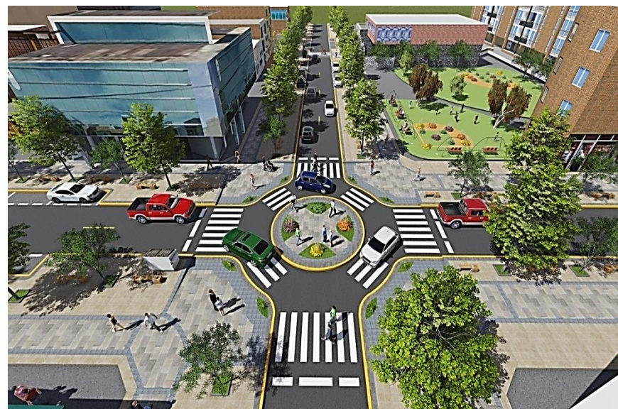
Imagen 19: intersección a nivel con rotonda entre dos colectoras locales o dos locales.
