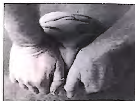
Amasado. Existen dos métodos para homogeneizar las arcillas plásticas a mano, eliminando las burbujas de aire. Uno consiste (izquierda) en partir la masa en dos, diagonalmente, y apretar una mitad encima de la otra, repitiendo la operación. La otra (arriba) es similar al amasado del pan, presionando rítmicamente con las palmas de las manos.
