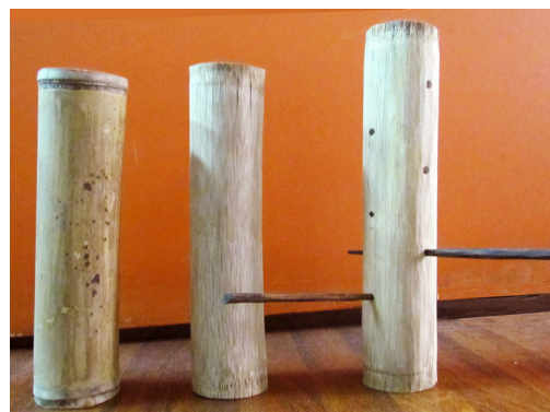
Fig. 10: a. Canuto sin tratamiento. b. Adelgazado. c. Cruce de los clavos de chonta.
