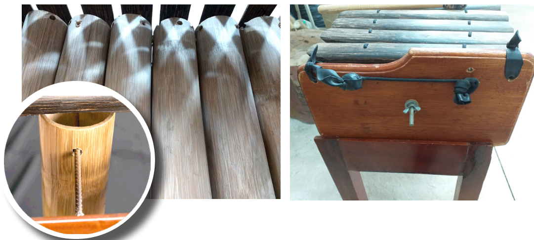
Fig. 40-41: Canutos con perforaciones para pasar la varilla de acero.
