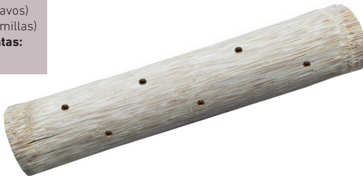
Fig. 7: Elguasá: bambú, y clavos de chonta.
