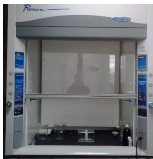
Figura 2.6. Campana de extracción de gases
