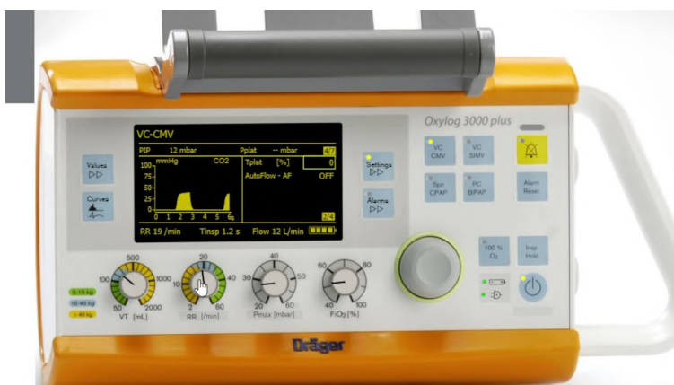
Ilustración 76: Ventilador mecánico de transporte
