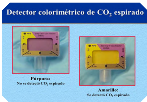
Ilustración 52: Detector colorimétrico de CO 2 expirado
