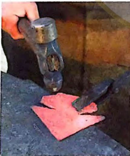
► 28. Sobre la bigornia cuadrada del yunque se doblan las pestañas de la pieza, necesarias para la sujeción de la aldaba a la chapa.
