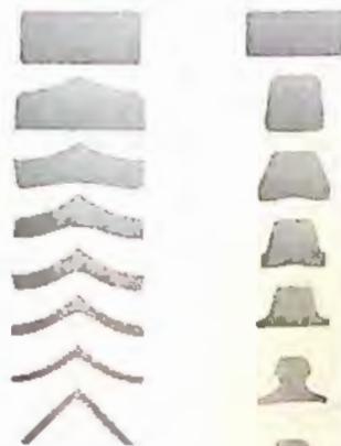
Secciones sucesivas obtenidas en cada grupo de cajas laminadoras hasta conseguir un perfil angular.
