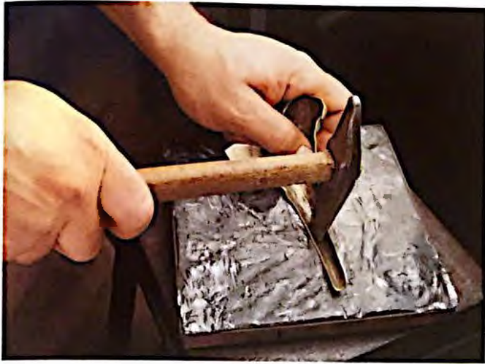
▲ 15. El conformado se realiza con diferentes martillos según las formas que se desee obtener.
