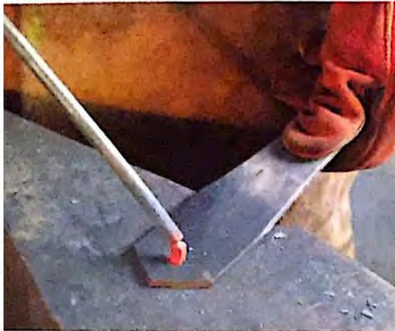
▲ 22. Se introduce la parte del clavo en una clavera y se dobla la barra hasta que se desprenda de ella por la marca de corte.
