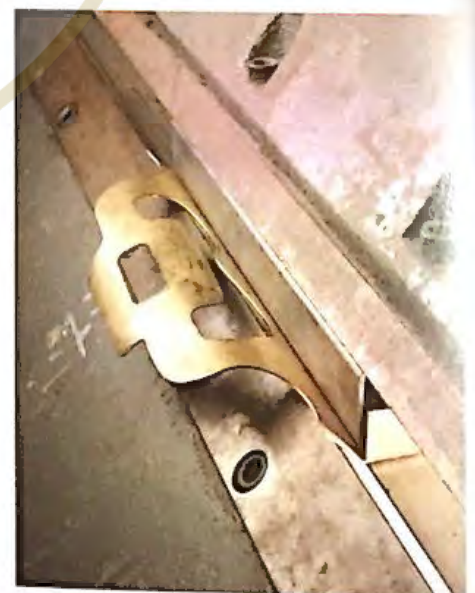
◀ 14. Después de curvar las asas se doblan los laterales con la plegadora. Una vez fijado el lateral de la bandeja entre las reglas de la plegadora se acciona la regla que efectuará el plegado.
