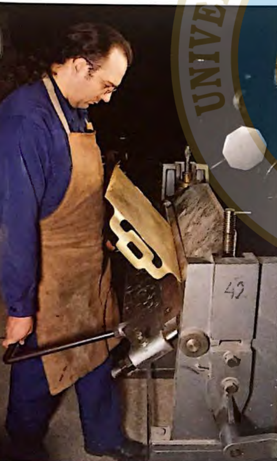
◀ 14. Después de curvar las asas se doblan los laterales con la plegadora. Una vez fijado el lateral de la bandeja entre las reglas de la plegadora se acciona la regla que efectuará el plegado.
