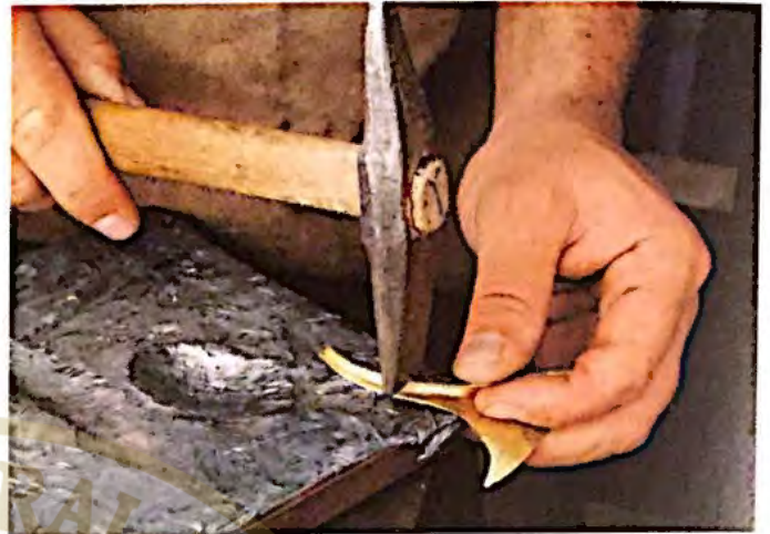
▲ ▼ 22 y 23. Se dobla y curva la parte de la ceja que debe encajar con la oreja, golpeando siempre sobre el tas de plomo.
