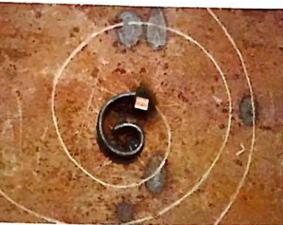
▲ 19. Ahora se empieza a fijar con puntos de soldadura el inicio de la espiral que conformará la plantilla a la plancha metálica. Se suelda también en este punto de inicio un tope cuadrado que permitirá trabar la varilla en el momento del forjado.
