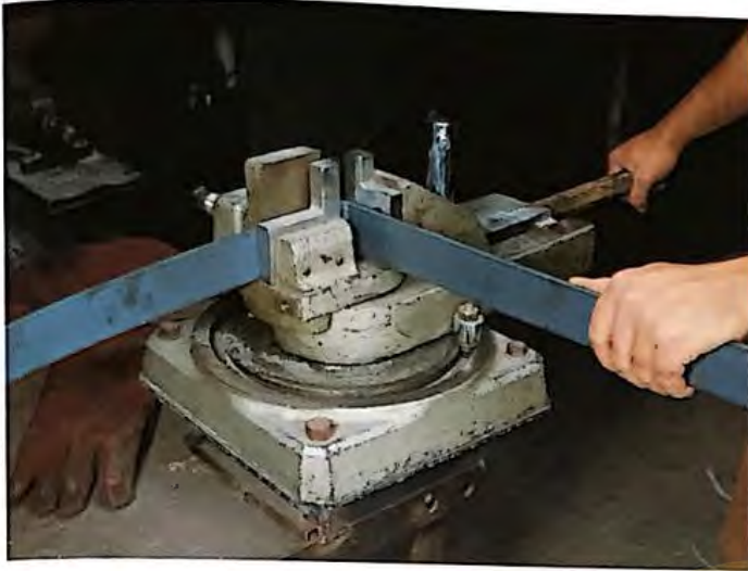
▲ 5. Se toma una pletina de hierro y se dobla con la plegadora de perfiles planos en un ángulo de 90^\circ , consiguiendo de este modo delimitar la base y un lado de la cancela.
