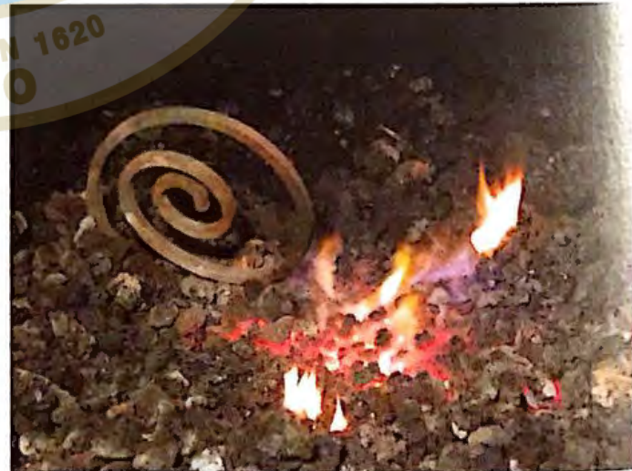
▼ 23. Se repite de nuevo y cuando se enfría el metal, se vuelve a lentar en la fragua.
