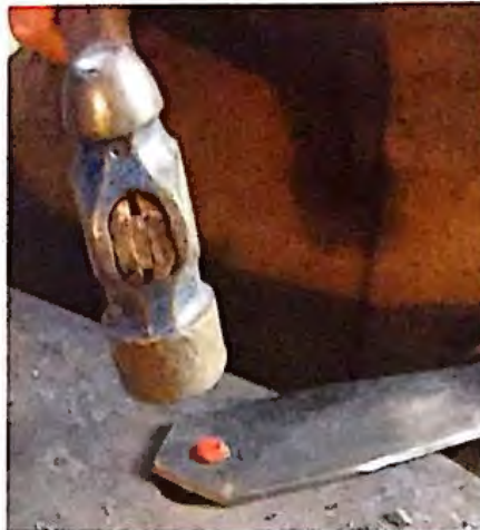
▲ 23. Para realizar la cabeza del clavo, se golpea la barra con el hierro al rojo.
