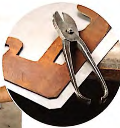
◀ 20. A continuación, se cortan seis chapas de aluminio de la misma medida que las caladas. Con unas tijeras de hojalatero se eliminan las esquinas de las planchas caladas de hierro y las de aluminio. Así se evita que los restos de soldadura existentes en las esquinas interiores de la estructura, difíciles de eliminar, impidan ajustar correctamente las dos chapas.
