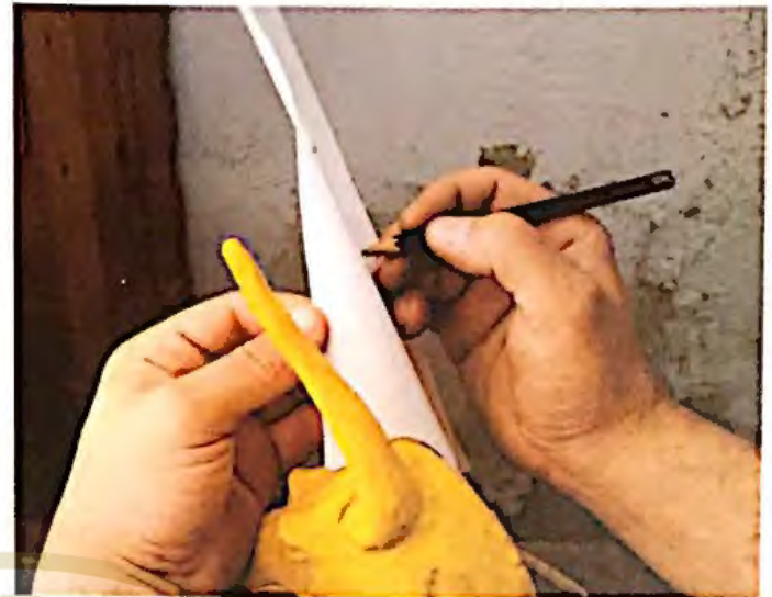
▲ 5. Una vez recortado el papel se encaja en el modelo y se continúa con el marcado y posterior recortado.
