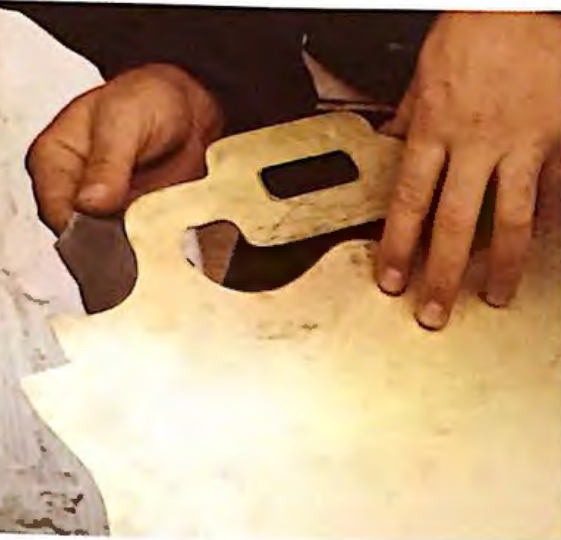
▲ 11. Con una tela de esmeril se eliminan de las aristas las marcas y rebabas producidas por la lima. De esta forma, se proporciona un tacto agradable al material.
