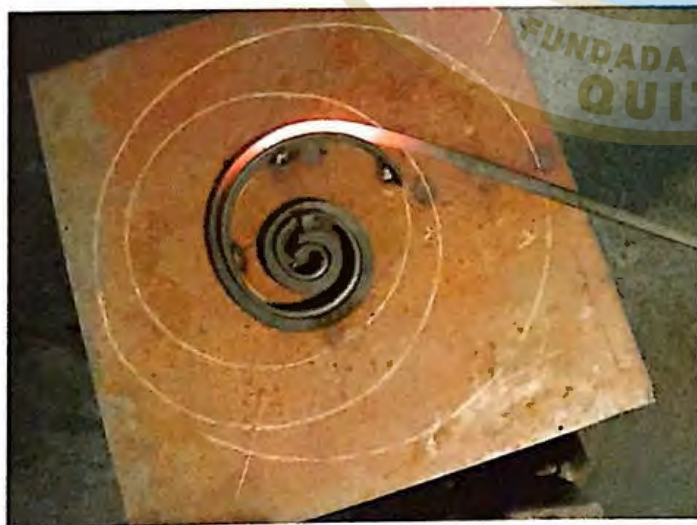
▼ 22. Se caldea solo el fragmento de la varilla a curvar, posteriormente se sujeta en la plantilla y se continúa el curvado en espiral.
