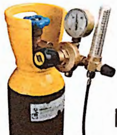
▼ Botella de gas protector utilizado en el procedimiento TIG, en este caso de argón.
