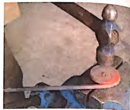
▲ Proceso de enrollado de una espiral por forjado.
