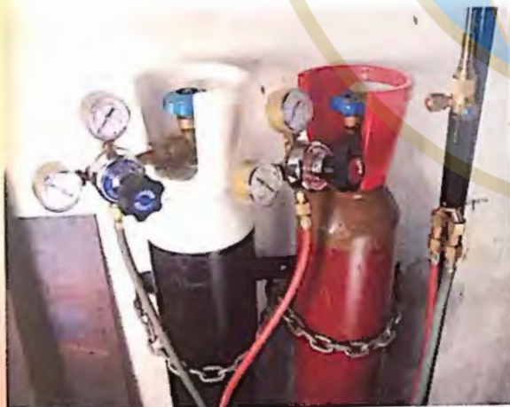
▲ Botellas de oxígeno (izquierda) y de acetileno debidamente sujetadas.
