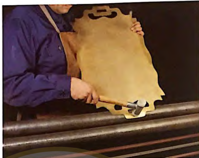
◀ 12. Para evitar el plegado que produce la máquina curvadora al inicio del curvado, se curva ligeramente el extremo de las asas con un martillo con cabeza de nailon sobre uno de los rodillos.
