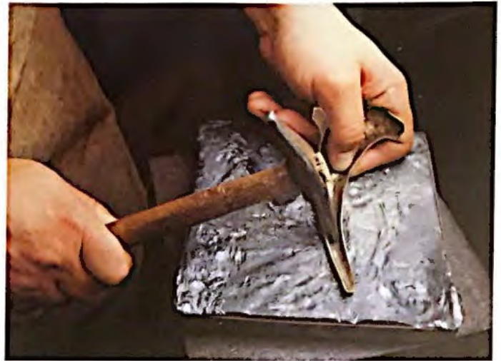
▲ 16. Uno de éstos es un martillo obtenido a partir de la reutilización de una piqueta de soldadura.
