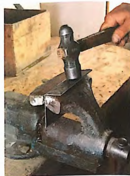
▲ 2. Sin variar el ritmo, se sigue doblando con golpes escalonados hasta conseguir el ángulo deseado.
