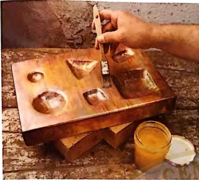
▲ 22. Para preservar los colores obtenidos al calentar la base del joyero se aplica sobre ésta un barniz a base de cera y resina de colofonia.
