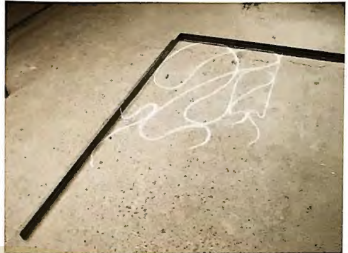
▲ 6. Sobre el dibujo del suelo se presenta la pletina doblada, se marcan los límites y se comprueba que el ángulo es correcto.
