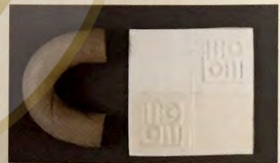
Pasta blanca de baja temperatura de cocción; la mitad con esmalte transparente
