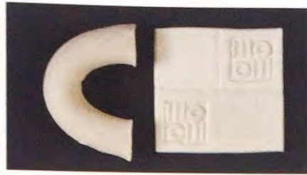
Porcelana de arcilla de papel; la mitad con esmaltado transparente
