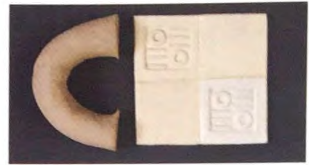
Arcilla de papel chamotada; un cuarto con esmaltado transparente, un cuarto con esmaltado de estaño
