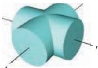
Intersección de dos cilindros
