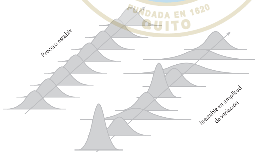
■ FIGURA 7.4 La carta R detecta cambios significativos en la amplitud de la dispersión. Por ejemplo, si la variabilidad aumenta (campana más amplia), la carta R lo detecta mediante uno o más puntos fuera de su LCS.
