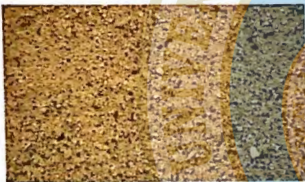
299. Aparejo preparado con arena de río; acabado liso.
