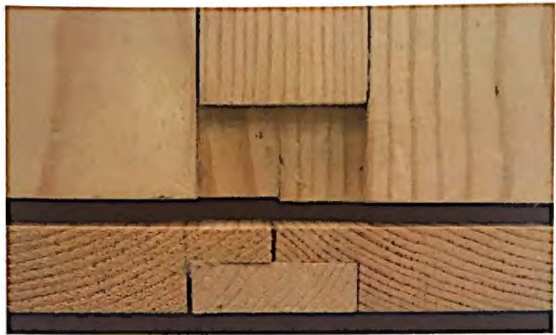
54. (a) Unión por falsa lengüeta. (b) Detalle.
