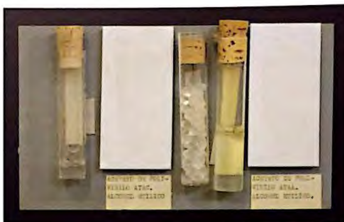
531. Acetato de polivinilo disuelto en alcohol etílico y acetato de polivinilo en estado sólido y disuelto en alcohol etílico.
