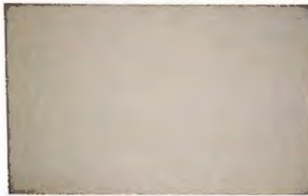
294. Aparejo preparado con yeso mate y resina acrílica.
