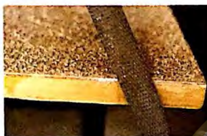
305. Afinado de los cantos del tablero con la escofina.
