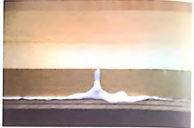
115. La cantidad de cola es la correcta cuando, una vez unidos los listones y el tablero, ésta rebosa moderadamente.
