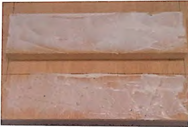
114. Aplicación del adhesivo en los listones y el tablero.
