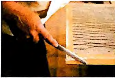
280. Afinado de los cantos del tablero con una escofina.
