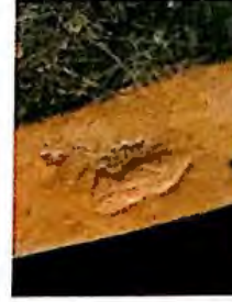
282. Defecto puntual por falta de poliéster.
