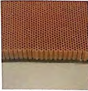
226. Celdillas hexagonales, o de nido de abeja, de cartón tratadas con resina fenólica.
