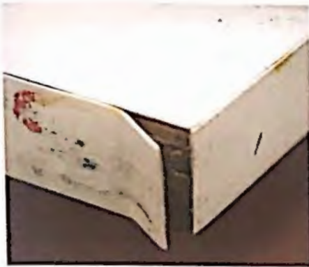
79. Canteado con laminado de formica.
