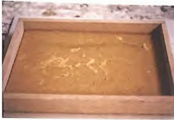
244. Molde tratado con pasta de parafina y esencia de trementina para desmoldear.
