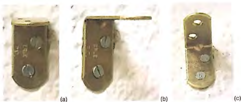
74. Diferentes vistas de una escuadra metálica para refuerzos de ángulos y para la fijación de tableros sobre el muro. (a) Vista frontal. (b) Vista lateral. (c) Vista desde abajo.
