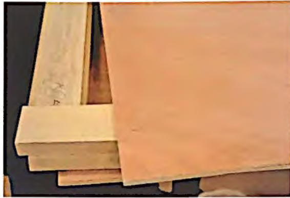
95. Selección de un tablero de contrachapado y de los listones.
