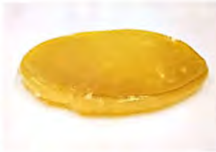
503. Placa de cola coagulada y lista para darle forma.
