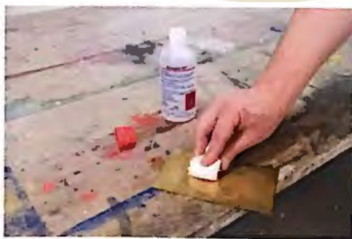
154. (a) Limpieza y desengrasado de la superficie de una plancha de cobre con alcohol. (b) Detalle.
