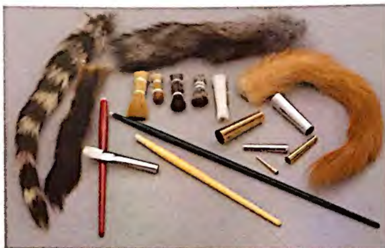
628. Colas y manojos de diferentes tipos de pelo, virolas y mangos para la fabricación de pinceles.
