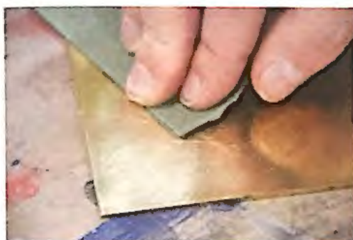
155. Tratamiento superficial de una plancha de cobre mediante lijado.
