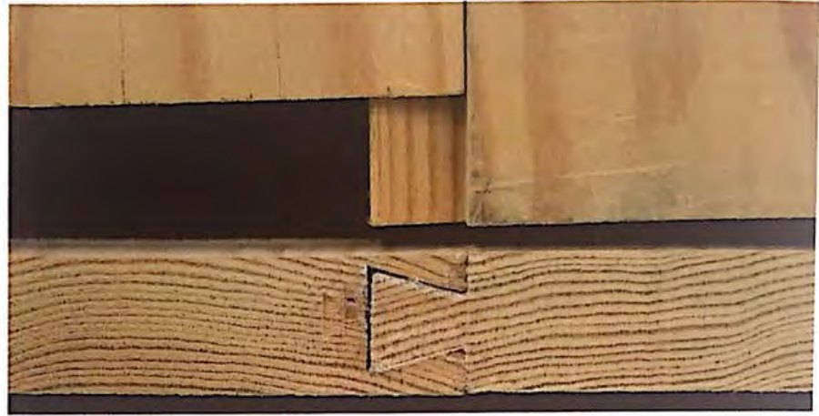
51. Detalle de un desplazamiento y un corte en sección por cola de milano.
