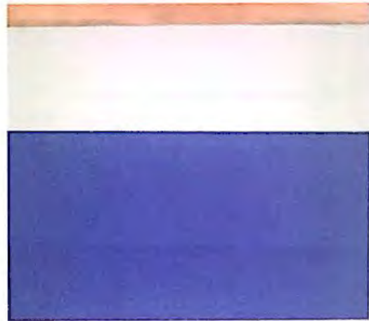
160. Placa de cobre tratada parcialmente con un aparejo cubriente, preparado con resina alquídica y blanco de titanio, y cubierta con una capa de pintura al óleo (azul de cobalto).
