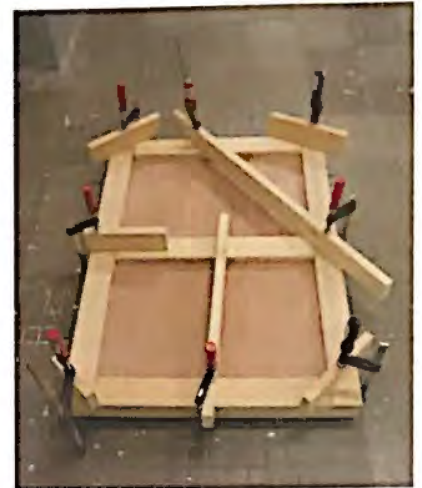
120. Prensado de los puntos difíciles y prensado final de todo el conjunto.
