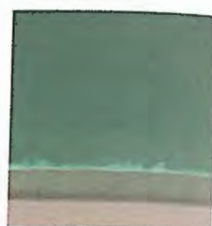
240. Fibra de vidrio tratada con resina de poliéster.
