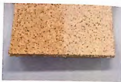
210. Lámina de corcho tratada parcialmente con Primal AC 33 espesado con tolueno.
