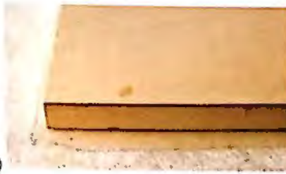
272. (a) Colocación de la plancha de poliuretano o el panel de celdillas sobre el tejido de fibra de vidrio impregnado con resina de poliéster. (b) Detalle.
