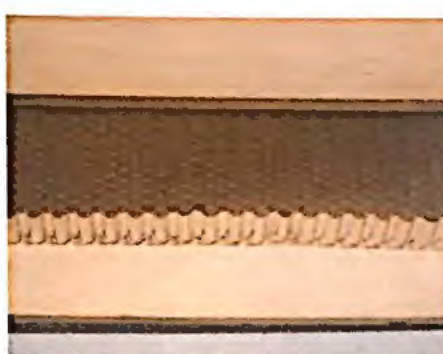
206. Capa base simétrica con núcleo alveolar o hueco (madera, celdilla de cartón con tratamiento fenólico y madera).
