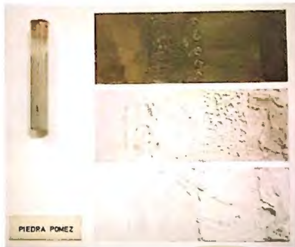
483. Piedra pómez amasada con resina acrílica con acabado en relieve.
