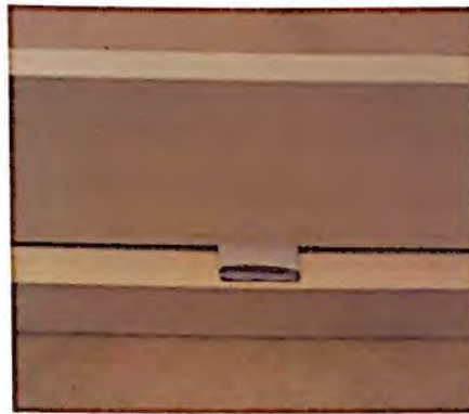
119. Detalle de la colocación de almohadillas de cartón en los puntos de prensado difíciles con la ayuda de tablancillos.
