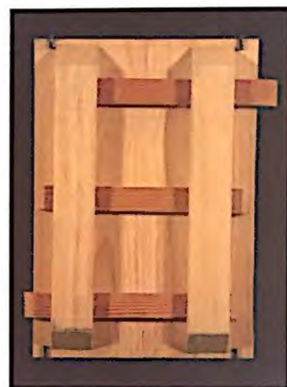
63. Refuerzo por engatillado.
