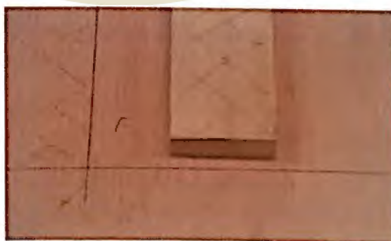
113. Aplicación de los cortes sobre los listones del bastidor y sobre los registros del tablero.
