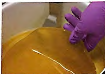
502. Después de coagulada la cola, se retira del molde con la ayuda de una espátula grande.
