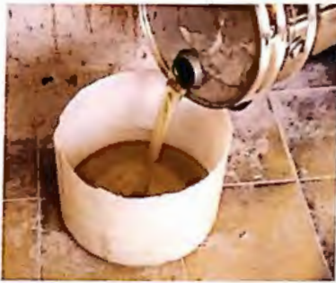
262. Vertido de la resina de poliéster.
