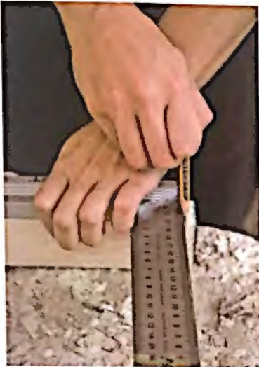
100. Trazado de una línea de corte en el extremo de un listón.
