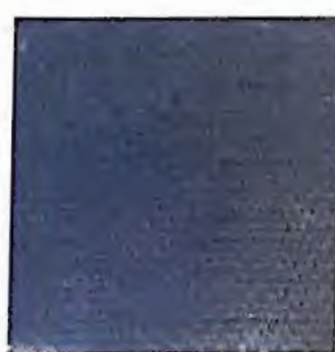
239. Tejido de fibra de vidrio tratada con resina epoxi.
