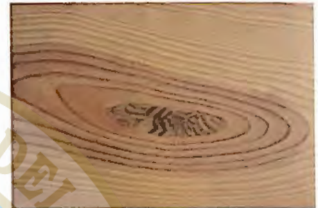
67. Eliminación de un nudo y embutido posterior de un taco de madera tallado en su lugar.
