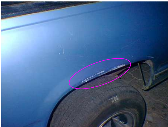
Figura 20. Rozamiento. Afectación de capa de pintura.
