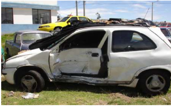
Figura 50. Daños materiales: puerta delantera con hundimiento en sus tres tercios producto de un choque lateral izquierdo perpendicular medio.
