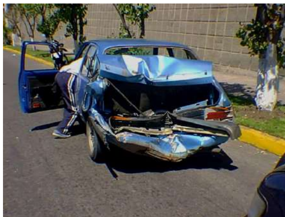
Figura 29. Choque por alcance. Impacto a alta velocidad. Destrucción total del porta maletas.
