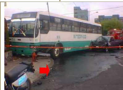
Huellas de líquido refrigerante del radiador.
